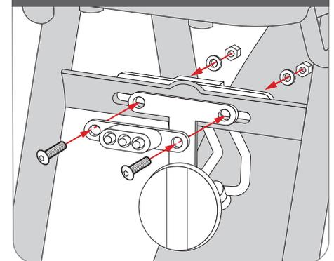
**FIRMLY TIGHTEN ALL BOLTS (MAX TORQUE 18Nm).**
